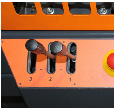
Bild 7 Hydraulikarmarna: 1. Positionen av utloppstransportör; 2. Positionen av hydrauliskt stocklyfte/inmatningstransportör (tilläggsutrustning). ”+” = upp och ”-” = ner
