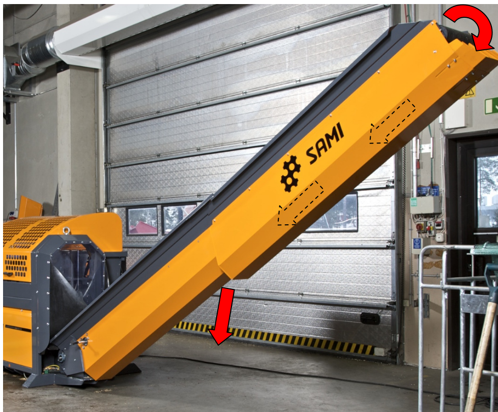
Bild 5 Funktionen av skräpavskiljaren i utloppstransportören.
