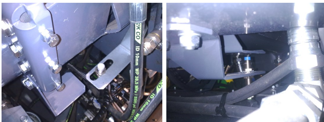
Bild 33. Klyvcylinderns induktiva givare fram och bak.
