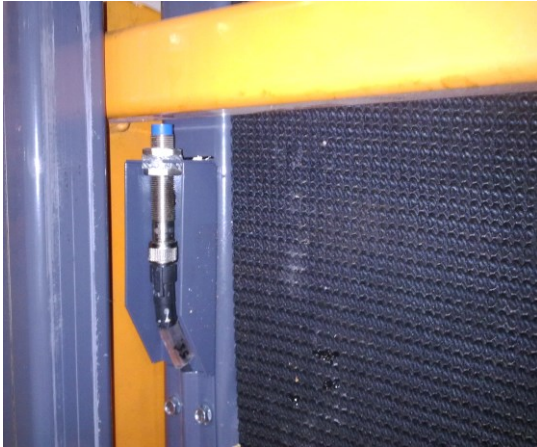
Bild 34. Stocklyftens induktiva givare
