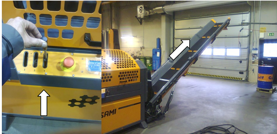
Bild 10. Användning av utloppstransportörens teleskopfunktion
