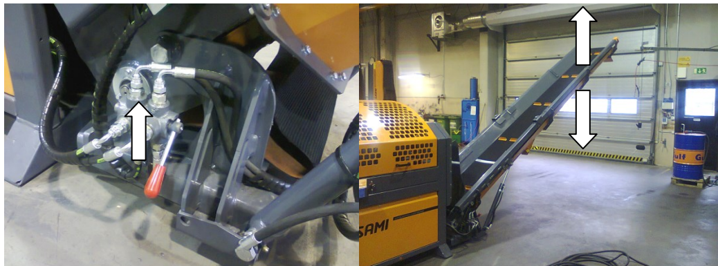
Bild 11. Höjdjustering av utloppstransportören
