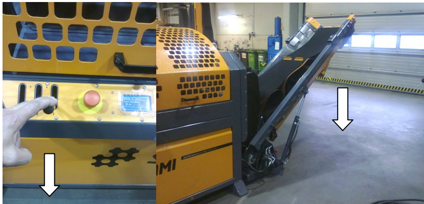
Bild 8. Sänkning av utloppstransportören.
