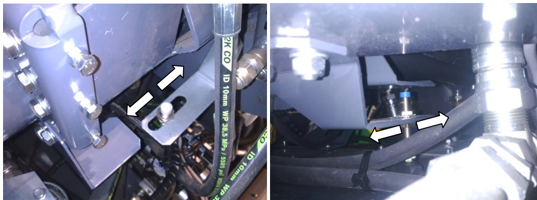
Bild 38. Justering av klyvcylinderns slaglängd
