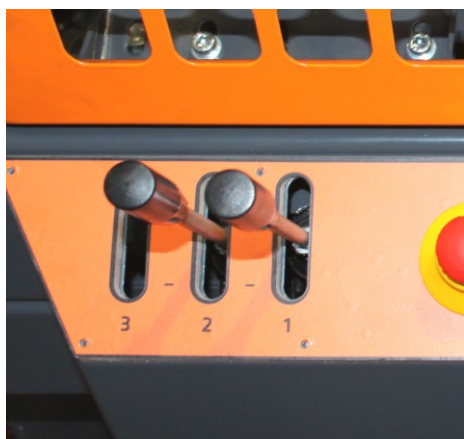
Bild 6. Hydraulspakarna: 1. Utloppstransportörens position; 2. Den hydrauliska stocklyftens /inmatningstransportörens position (tilläggsutrustning). ”+” = upp och ”-” = ner
