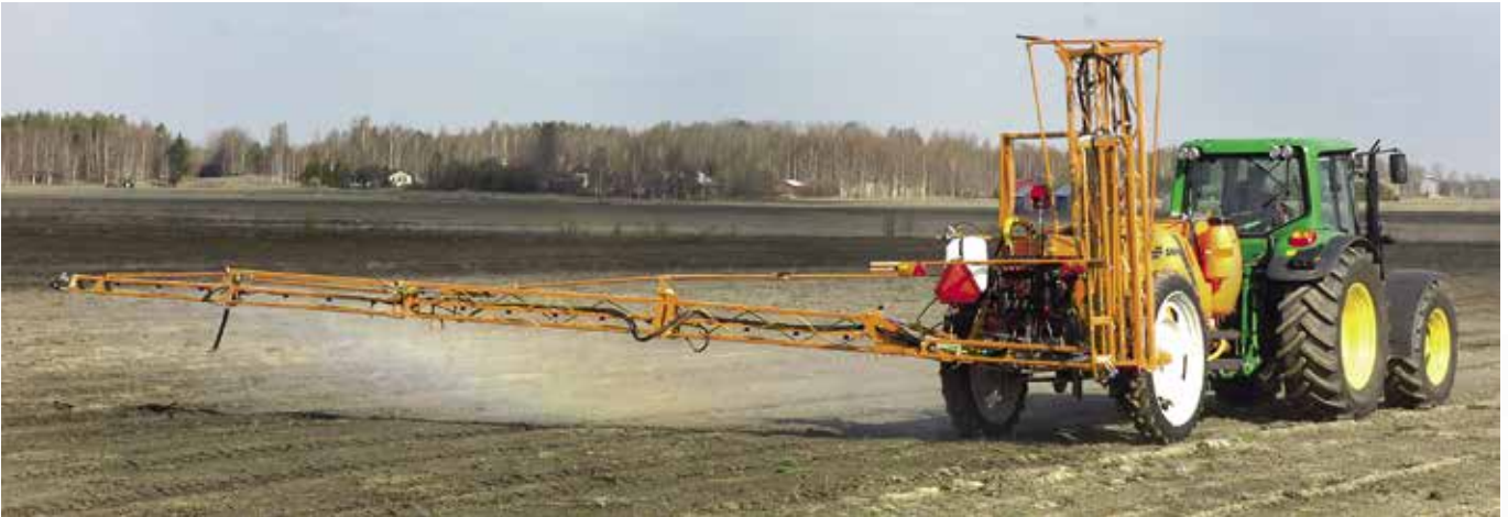
SAMI 6/2300+500/21H Elektro 5-lohkoinen digitaalisella painemittarilla. Lisävarusteina vahtomerkitsin, pesusuuttimet ja sähköinen puomiston kallistussylinteri.
