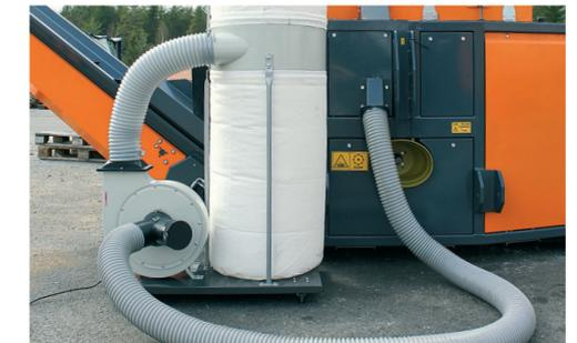
**L'ASPIRATEUR À SCIURE** extrait la sciure dans un conteneur. L'alimentation du petit modèle sur secteur et du grand modèle par prise de force.
