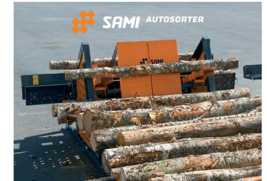
**SAMI AUTOSORTER** peut comprendre une table de chargement, un trieur ainsi qu'un convoyeur de transfert. Lorsque SAMI Autosorter est intégré à SAMI Autochopper, tout le processus devient complètement automatisé.
