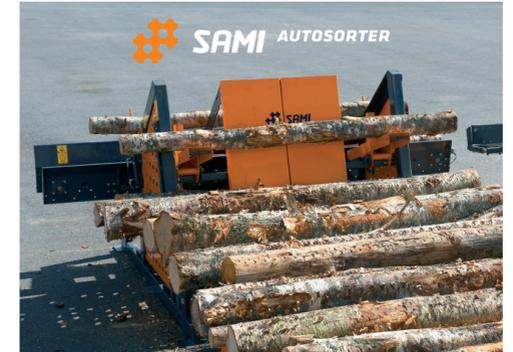
**DER SAMI AUTOSORTER** umfasst in seiner Gesamtheit einen Holzaufletisch, einen Stammtrenner und einen Querförderer. Mit einem SAMI Autosorter integriert an dem SAMI Autochopper läuft die ganze Brennholzproduktion völlig automatisch.
