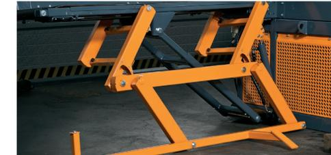
**DER HYDRAULISCHE STAMMHEBER** verringert die anstrengenden Handarbeiten und ist sicher in der Anwendung, weil das Anheben direkt nach oben erfolgt. Der Stammheber ist am Zuführtisch befestigt und wird nicht am Boden abgestützt. Dadurch folgt der Stammheber praktischerweise dem Zuführtisch und ist immer betriebsbereit.
