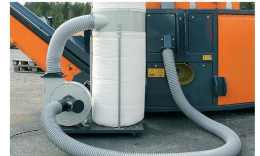
**DIE SPÄNEABSAUGANLAGE** saugt die Späne sauber in einen Behälter ab. Das kleinere Modell wird mit Netzspannung betrieben, der größere Saugapparat verwendet Starkstrom.
