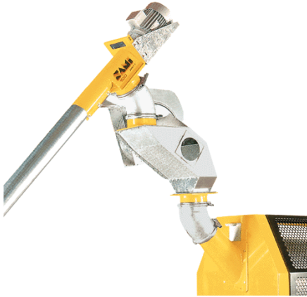
Kuva 5. Ruuvikuljetin ja esipuhdistin liitettynä syöttöputkeen.
