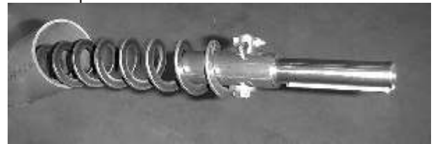
22. Asenna akseli spiraaliin. Huom. Lukituslovi spiraaliin ja kiristys M10 pultilla akselia vasten.
