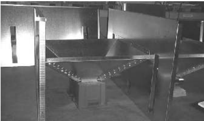
3. Liitä suppilot jalkaelementteihin. Käytä apuna koroketta. Huomio jalkojen asento.
