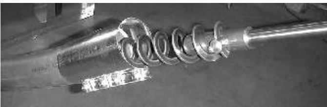
23. Pujota putken jatkopala.
