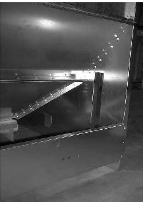
11. Asenna suppilon jatkopalat ja sokkelpalat.
