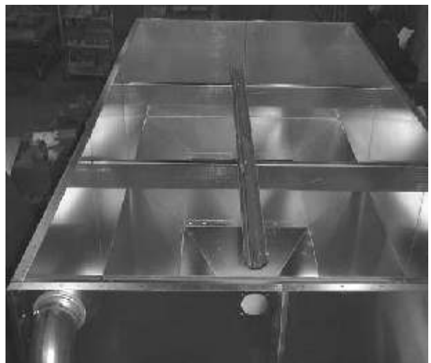
16. Kasaa koko kerros. Asenna poikkituet ja täyttöputken ohjaukourut kuvan mukaisesti. Korkeus täyttöputken reiän mukaan.
