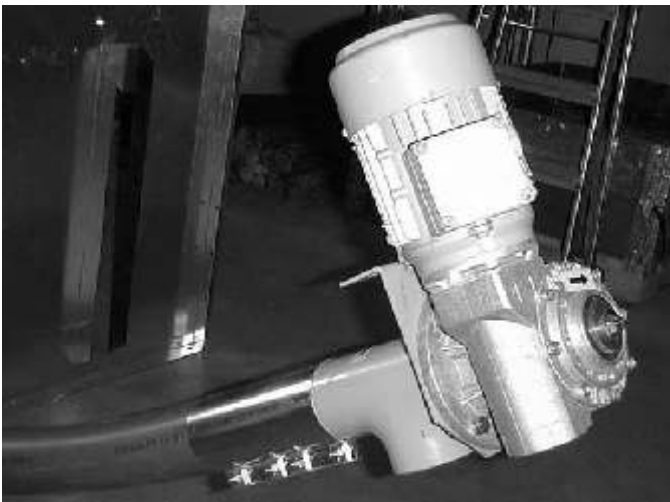
25. Työnnä vaihdemoottori akselille ja hae suunta sopivaksi. Kiinnitä vaihde M10 pultein ja lukitse akseli päästä M10 pultilla. Tue vaihdepaketti rakenteisiin.
