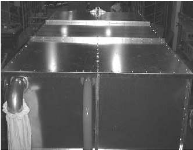
19. Asenna katto aloittaen keskimmäisestä osasta. Asenna seuraavaksi kulmaosat (2 erilaista) kuvan mukaan.
