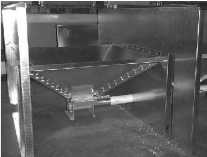
9. Asenna tukipää paikoilleen suppiloon. Muista sulkuluukku väliin.
