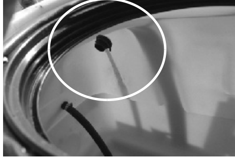
Kuva 2. Vesiletkun kiinnitys säiliön sisäpuolelta
