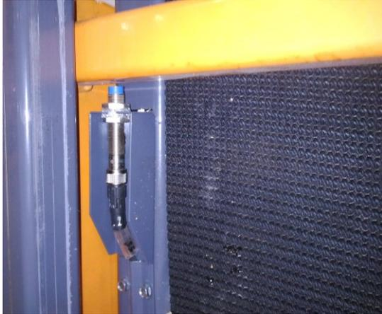
**Figure 34.** Détecteur inductif de l'élévateur
