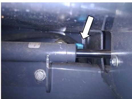
Figure 36. Soupape de réglage du pousseur
