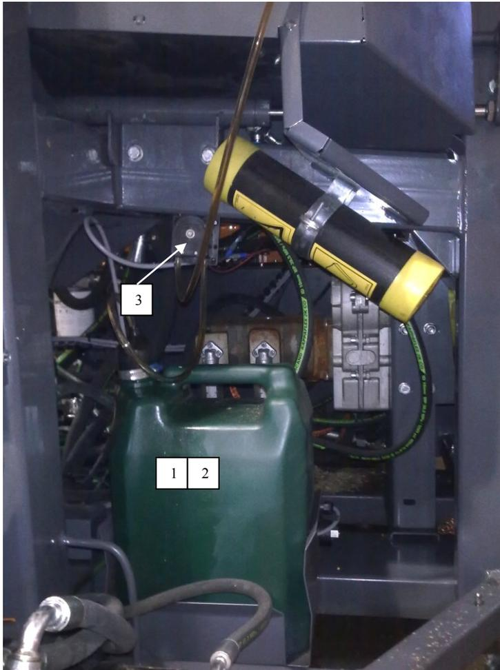
**Figure 63.** Réservoir d'huile de la chaîne de tronçonneuse
