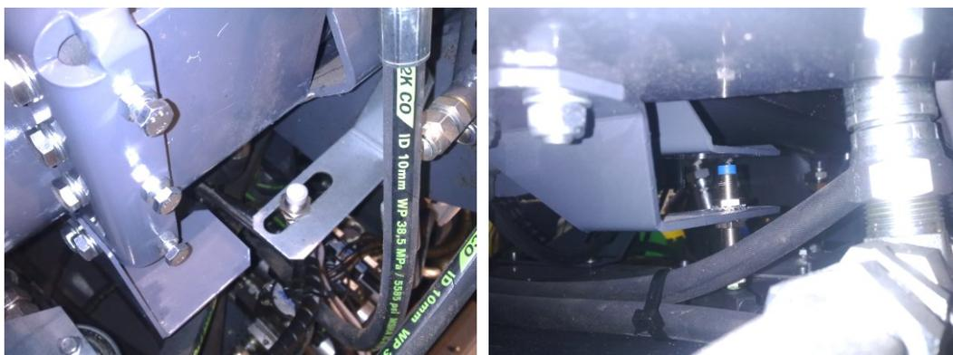
**Figure 33.** Détecteurs inductifs du cylindre de fendage
