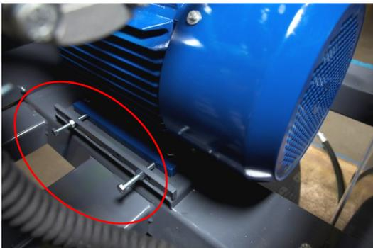
Figure 53. Resserrage des courroies avec les vis dans la base du moteur
