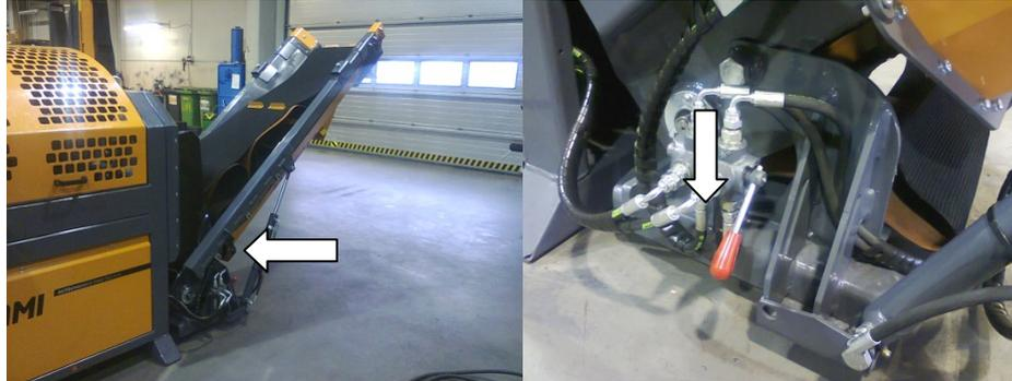
**Figure 9.** Mettre la soupape manuelle en position basse
