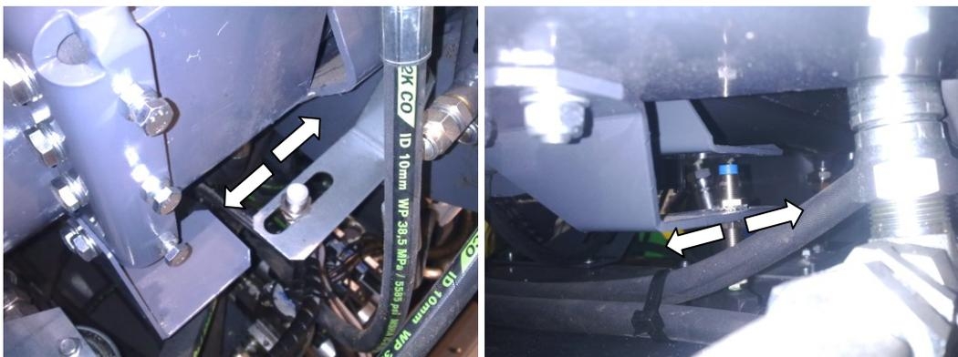
**Figure 38.** Réglage de la durée du coup de piston du cylindre de fendage
