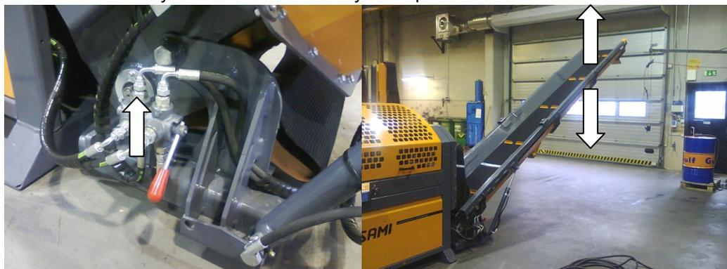
**Figure 11.** Ajustement de la hauteur du convoyeur d'évacuation
