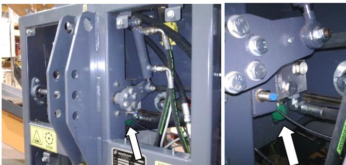
**Figure 37.** Réglage de la vitesse du tapis d'alimentation
