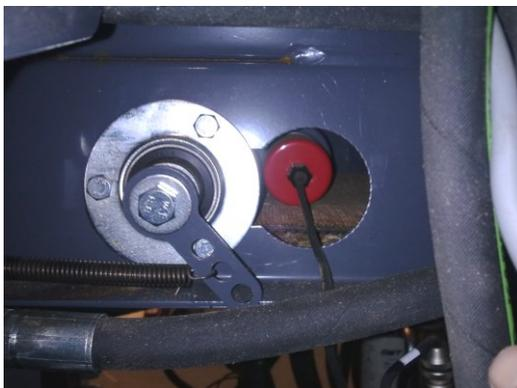
Figure 29. Détecteur d'angle de la table d'alimentation
