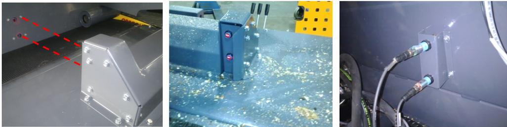
Figure 28. Détecteurs optiques de la table d'alimentation
