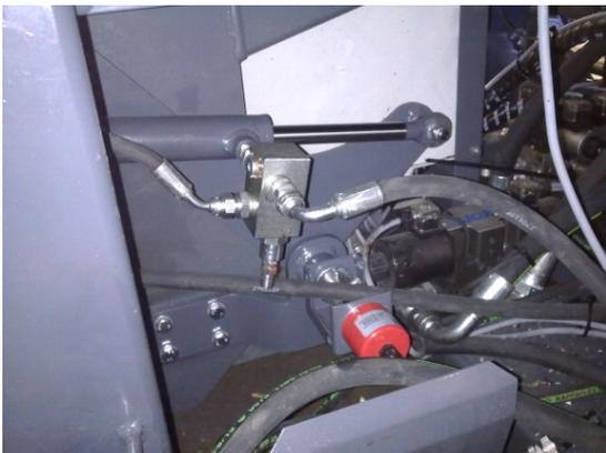
**Figure 57.** Palier du levier de la lame de fendage 1 graisseur
