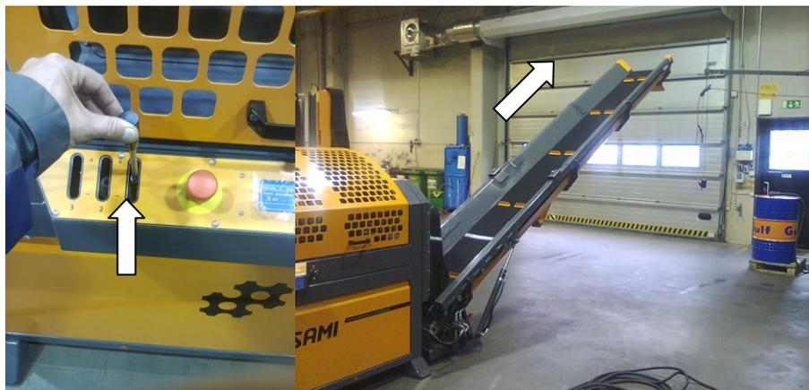
**Figure 10.** Utilisation du télescope du convoyeur d'évacuation
