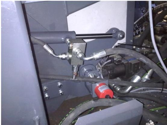
**Figure 31.** Détecteur d'angle de la lame de fendage
