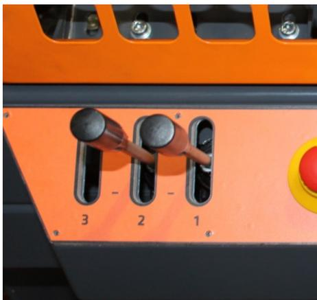
Figure 6. Leviers hydrauliques : 1. Position du convoyeur d'évacuation ; 2. Position de l'élévateur hydraulique / du convoyeur d'alimentation (accessoire). « + » = position haute ; « - » = position basse
