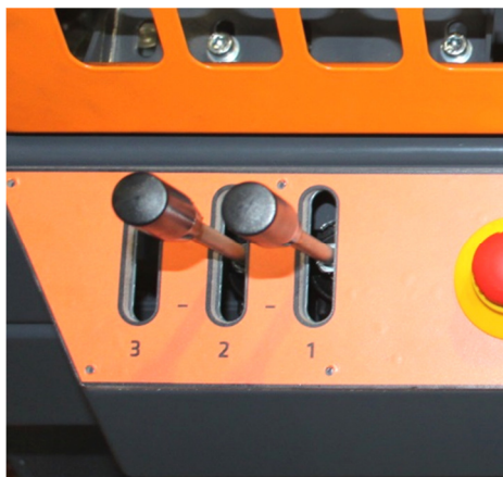
Kuva 6 Hydraulikkavivut: 1. Poistokuljettimen asento; 2. Hydraulinen puunnostin /syöttökuljettimen asento (lisävaruste). ”+” = kuljetin ylös ja ”-” = kuljetin alas
