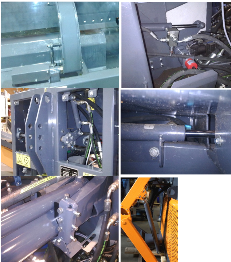
Kuva 55 Hydraulisyliinterien (7 kpl) nivelpäät 14 kpl
