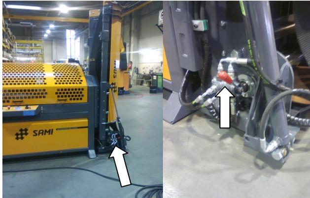
Illustration 7. Das manuelle Ventil des Abzugsförderers in aufrechter Position
