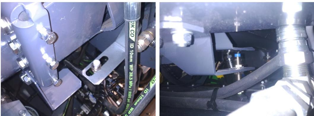
**Illustration 33.** Die induktive Sensoren des Spaltzylinders
