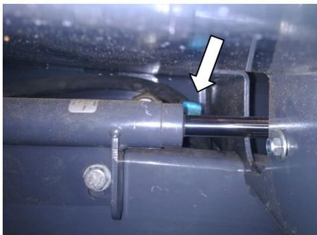
Illustration 36 Geschwindigkeitsregelventil des Stammförderers
