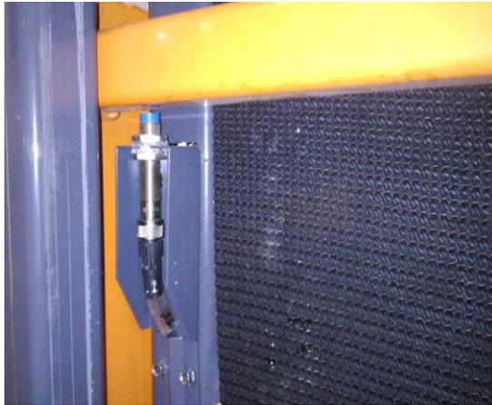
**Illustration 34.** Der induktive Sensor des Stammhebers
