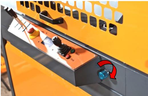
Illustration 35 Geschwindigkeitsregelventil des Schneidauslegers
