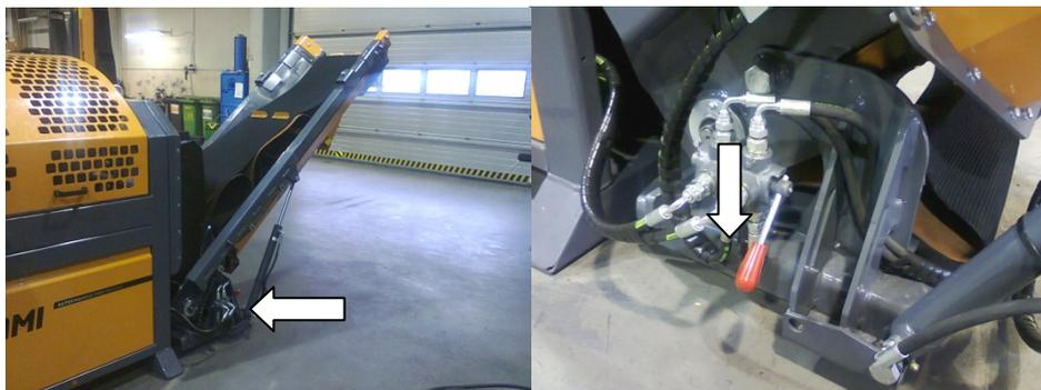
Illustration 9. Das manuelle Ventil des Abzugsförderers in die untere Position.
