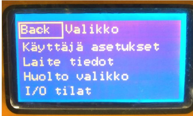
**Illustration 15.** Menü (in das Menü beim Drücken der oberen Taste der Joysticksteuerung)
