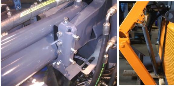
**Illustration 55** Gelenkstangenköpfe 14 Stücke der hydraulischen Zylinder (7 Stücke)
