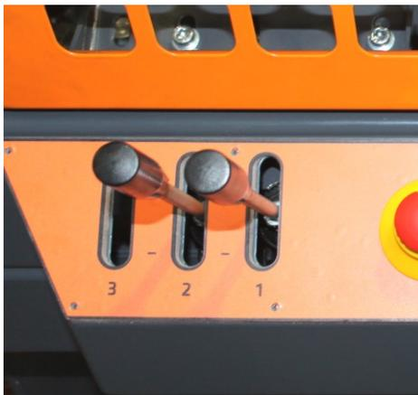
**Illustration 6** Hydraulikhebel: 1. Position des Abzugsförderers; 2. Hydraulischer Heber/Position des Vorschubförderers (Zusatzgerät). ”+” = Förderer hoch und ”-” = Förderer unter
